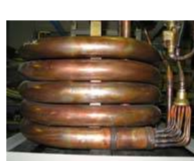
図 11 熱交換器（左：銅多重管式、右：プレート式）
